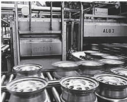
Алюминиевая промышленность: печь отпуска колес
